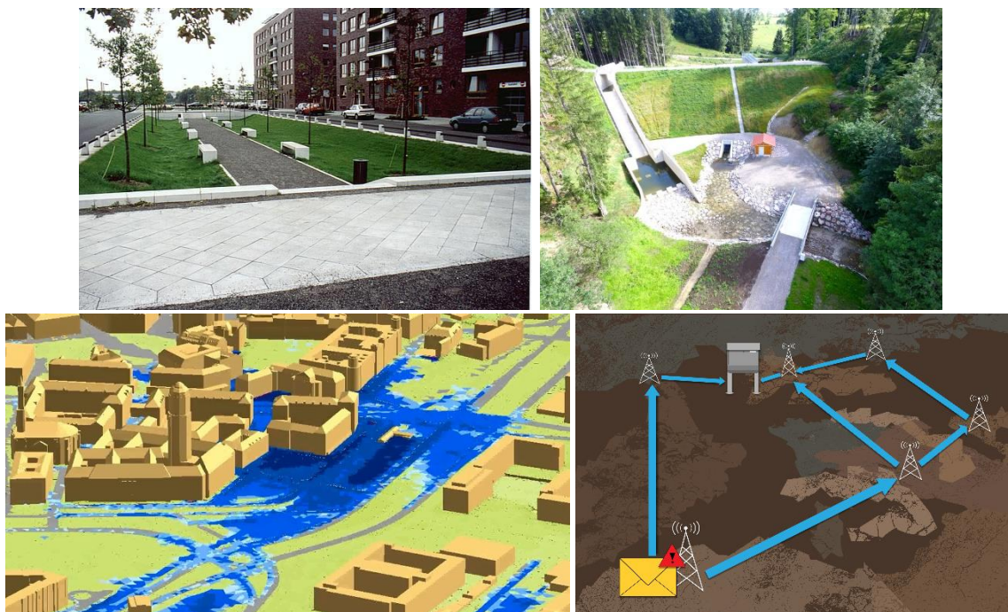
Abbildung 8: Beispiele für Risikobewältigungsmaßnahmen: dezentraler Rückhalt mit Versickerung links oben (Prof. Dr. Sieker GmbH), zentrale Rückhalteanlagen rechts oben (WWA Kempten), hydrodynamische Fließwegsimulation links unten (itwh GmbH) und Starkregen-Frühwarnsysteme rechts unten (TU Darmstadt, A. Hirsch)
